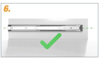
Außenschiene muss parallel zum Boden verlaufen.
