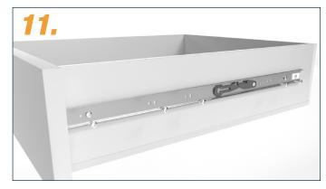
Innenschiene mit Schrauben befestigen. Bei Metall-Korpus z.B. mit Flachkopfschraube M4x8, bei Holz-Korpus z.B. mit Flachkopfschraube 4x14 (bei uns im Onlineshop erhältlich).
