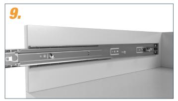
Außenschiene mit Schrauben befestigen. Bei Metall-Korpus z.B. mit Flachkopfschraube M4x8, bei Holz-Korpus z.B. Flachkopfschraube 4x14 (bei uns im Onlineshop erhältlich).
