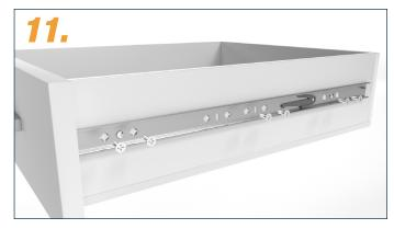
Innenschiene mit Senkkopfschrauben befestigen. Bei Metall-Korpus z.B. mit Senkkopfschraube M5x16, bei Holz-Korpus z.B. mit Senkschraube 4,5x16 (bei uns im Onlineshop erhältlich).
