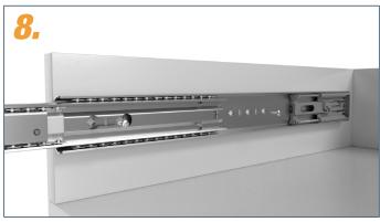
Außenschiene kann mit Schrauben in den Langlöchern fixiert und noch ausgerichtet werden. z.B. mit Rundkopfschraube 4mm (nicht im Lieferumfang). Schrauben können nach der Montage optional wieder entfernt werden.
