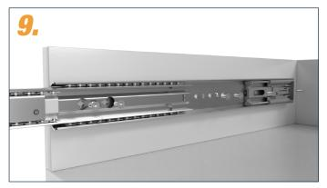
Außenschiene mit Senkkopfschrauben befestigen. Bei Metall-Korpus z.B. mit Senkkopfschraube M5x16, bei Holz-Korpus z.B. mit Senkschraube 4,5x16 (bei uns im Onlineshop erhältlich).
