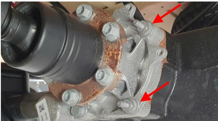
Bei Fahrzeugen nach UNECE-Vorgaben ab Mj 2025 müssen die beiden im Bild gekennzeichneten Schrauben durch die als Zubehör mitgelieferten Schrauben mit Stehbolzen M10x55/M8x16 ersetzt werden. Die Schrauben sind nach den Vorgaben des Fahrzeugherstellers festzuziehen.
