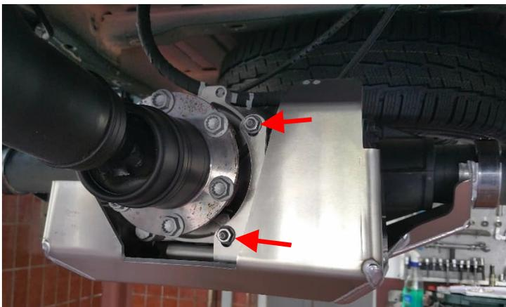
Die Schutzplatte für Haldex & Differential an den Stehbolzen für den Haldex-Steinschlagschutz und am Achsrohr befestigen.
