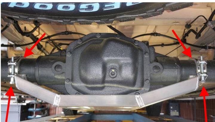
Die beiden mitgelieferten Halbschalen links und rechts auf das Achsrohr legen und an den Halbschalen der Schutzplatte ausrichten.
