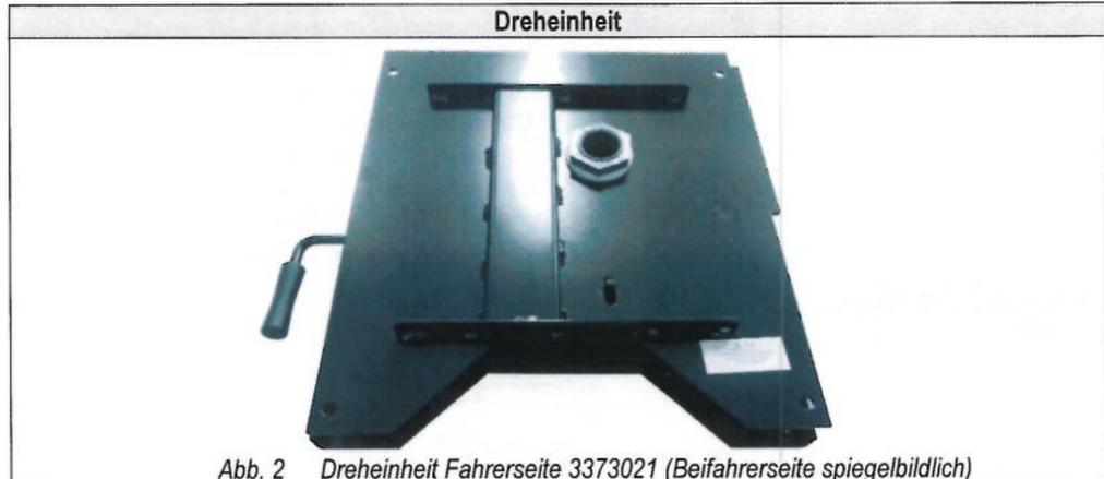
Abb. 2 Dreheinheit Fahrerseite 3373021 (Beifahrerseite spiegelbildlich)
